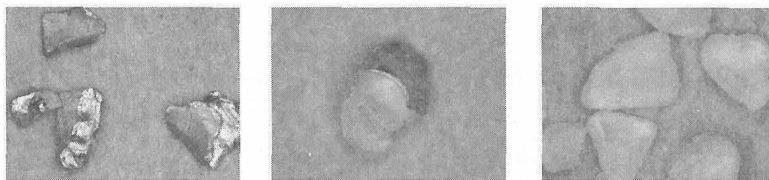
写真1 樹脂めっきを微粉砕化したときにできる微粒子の種類
